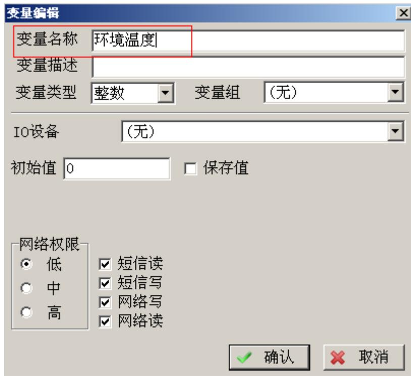
**注意：** GRM 设备内部工程因增加变量、删除变量或修改变量名称而发生变化时，需下载新工程到 GRM530 正常运行后，并使用 GrmOpcMgr 重新刷新 GRM 设备，才能自动获取最新的 OPC 寄存器名。
