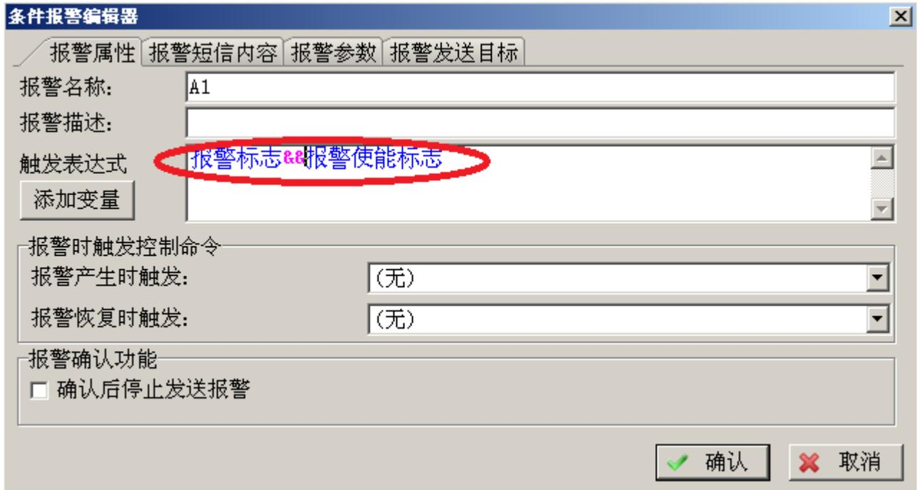
以上触发表达式的含义是：当报警标志和报警使能标志两个变量都为 1 时，才触发报警。因此要禁用报警时，只需利用短信写变量的功能，发短信将报警使能标志写 0，即可禁用报警，将报警使能标志写 1，重新激活该报警。
