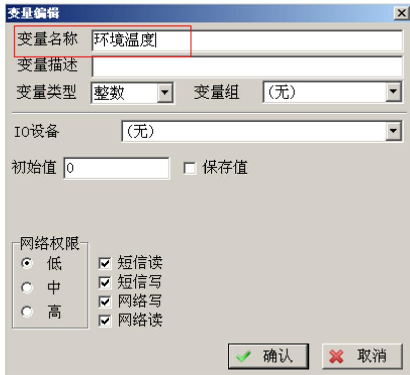
**注意：** GRM 设备内部工程因增加变量、删除变量或修改变量名称而发生变化时，需下载新工程到 GRM530 正常运行后，并使用 GrmOpcMgr 重新刷新 GRM 设备，然后退出 WINCC，再重新进入 WINCC 回到上图的界面，才能自动获取最新的 OPC 寄存器名。
