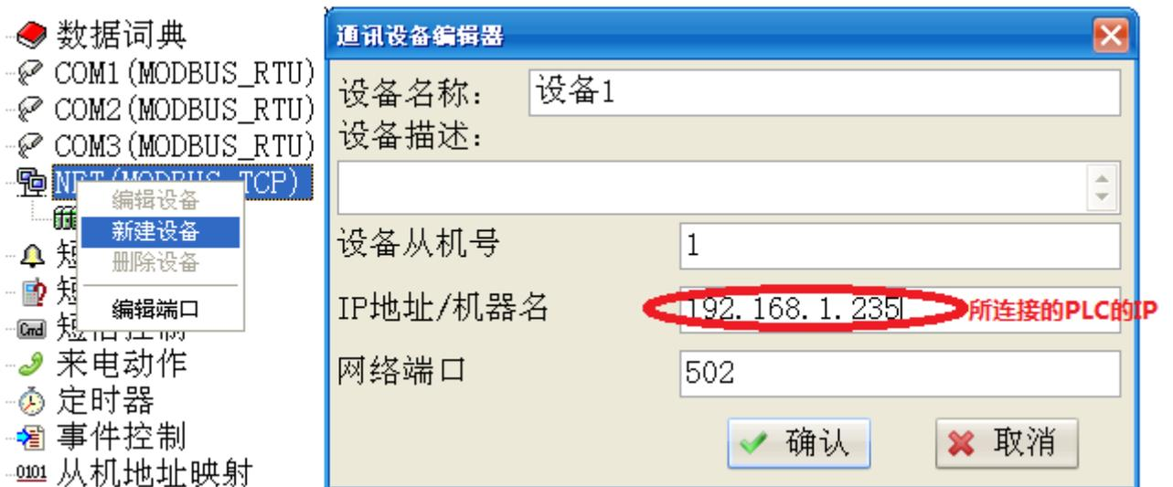
4) 在数据词典中，将变量关联到相关通讯设备的 PLC 寄存器地址。
