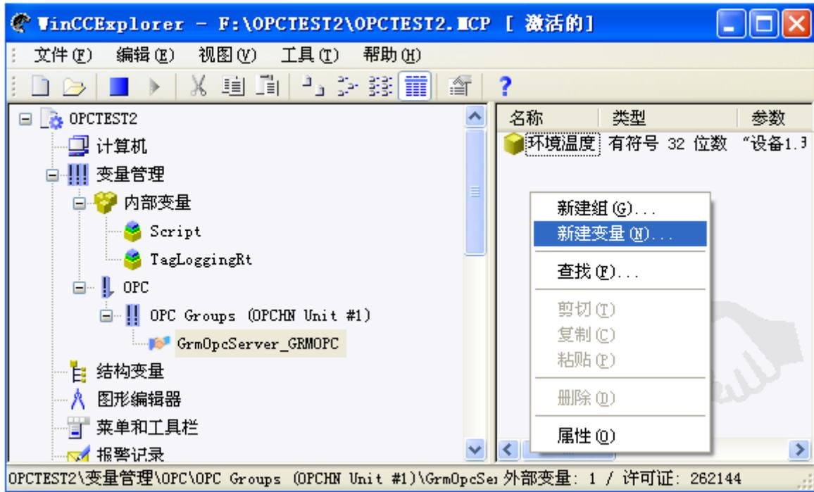
变量属性中 数据类型和 GRM530 中一致。GRM 设备变量中整数类型对应 WINCC 有符号 32 位数，开关量类型对应 WINCC 中二进制变量，浮点数类型对应 WINCC 浮点数 32 位 IEEE 754。
