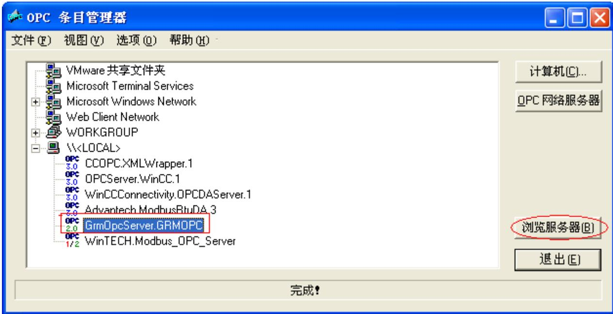
点击“浏览服务器”后，WINCC 会自动启动 GrmOpcServer，如下图。并同时弹出“过滤标准”对话框
