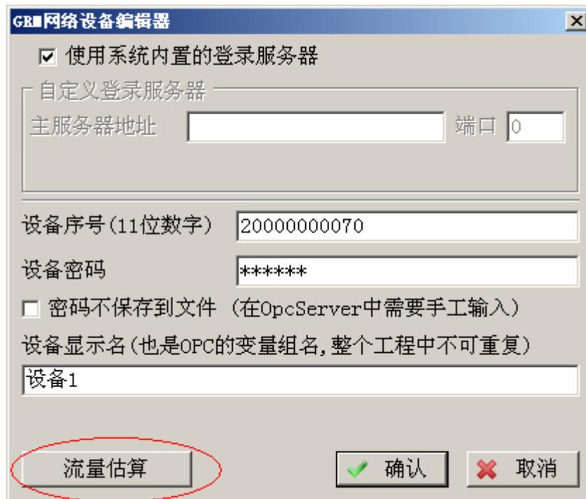
GRM 根据输入的工作时间，工作天数，刷新间隔，计算出当前 GRM 工程的流量费用。
