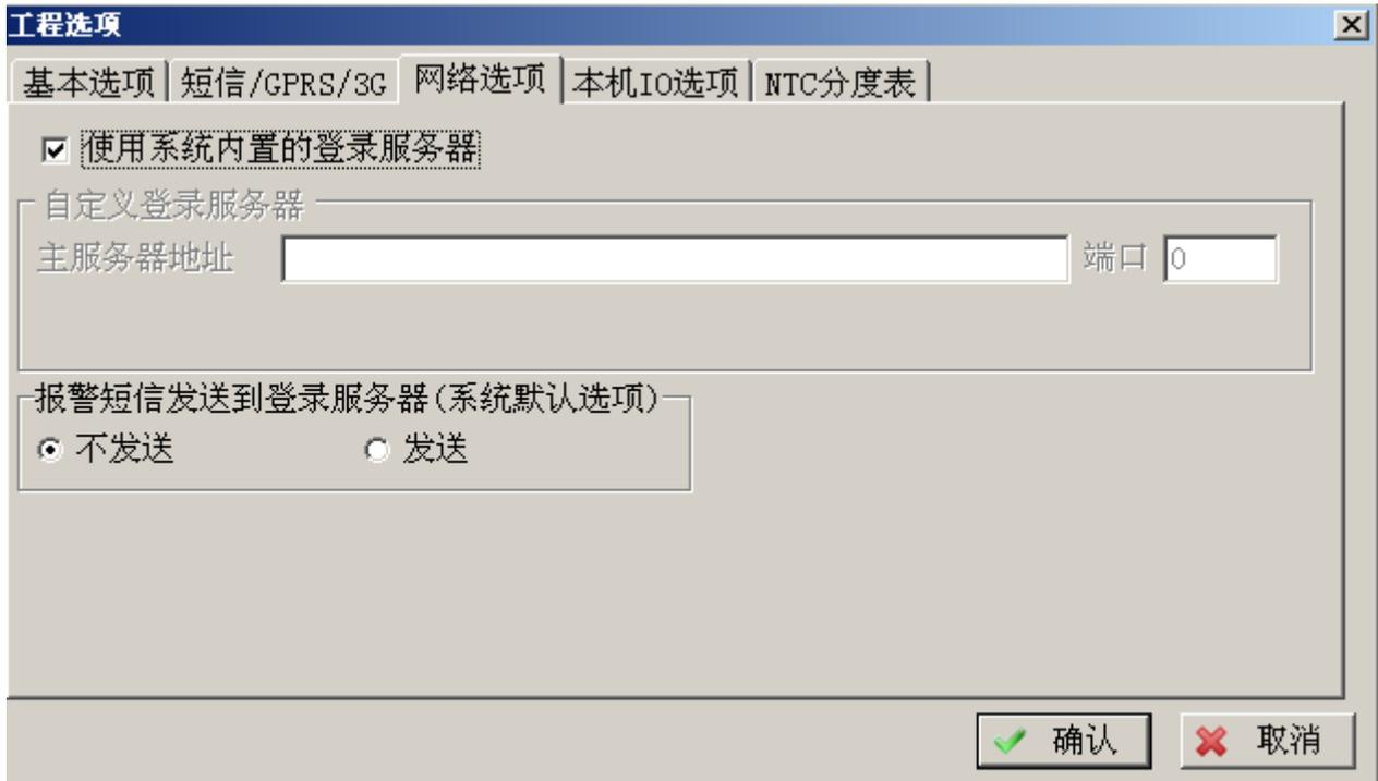
服务器地址：云监控服务器地址，除非自己搭建服务器，一般情况请勾选使用默认服务器。
