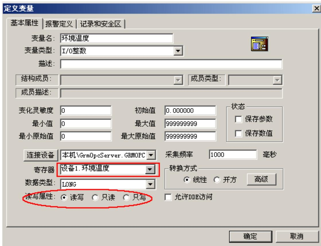
上图中数据类型和 GRM 设备中定义的变量类型需保持一致。GRM 设备变量整数对应组态王 LONG，开关
