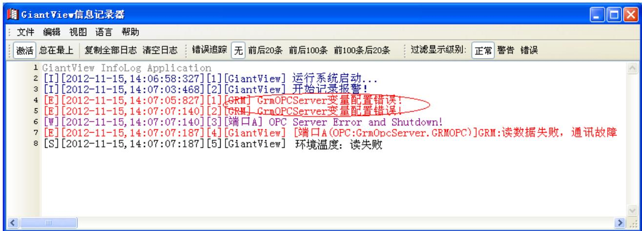
提示表明巨控组态中用到的变量**环境温度**在 OPC 服务器中并不存在，原因是因为该变量在 GRM530 中根本不存在，或者 GRM530 中有该变量，但是没有正常刷新到 OPC 服务器。这个时候，请重新下载正确的 GRM530 工程，并刷新设备，请参考**配置和刷新 GRM 设备**章节。
