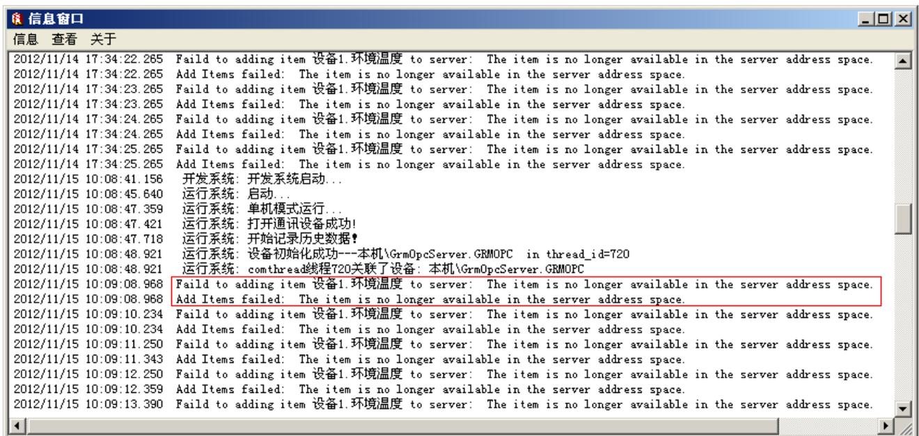
以上提示表明组态王中用到的变量**环境温度**在 OPC 服务器中并不存在，原因是因为该变量在 GRM530 中根本不存在，或者 GRM530 中有该变量，但是没有正常刷新到 OPC 服务器。这个时候，请重新下载正确的 GRM530 工程，并刷新设备，请参考**配置和刷新 GRM 设备**章节。
