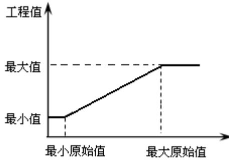
**举例：**有一个 IO 设备为电压仪表，在实际电压为 0 时产生 0 值，在满量程 500V 时产生 1024 的值。如果我们希望将采集的 IO 数据（0-1024）直接转换成实际对应的电压（0-500V），可以将变量“电压”设置如下：
