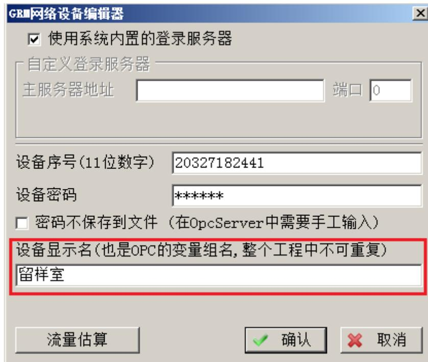
2: 在组态软件中，OPC 驱动和设备仍然只需要有一个，只需在 OPCMANG 里面登陆多个模块，组态软件浏览变量的时候，会看到该 OPC 设备下有登陆的各个模块的变量(按设备显示名区分)。
