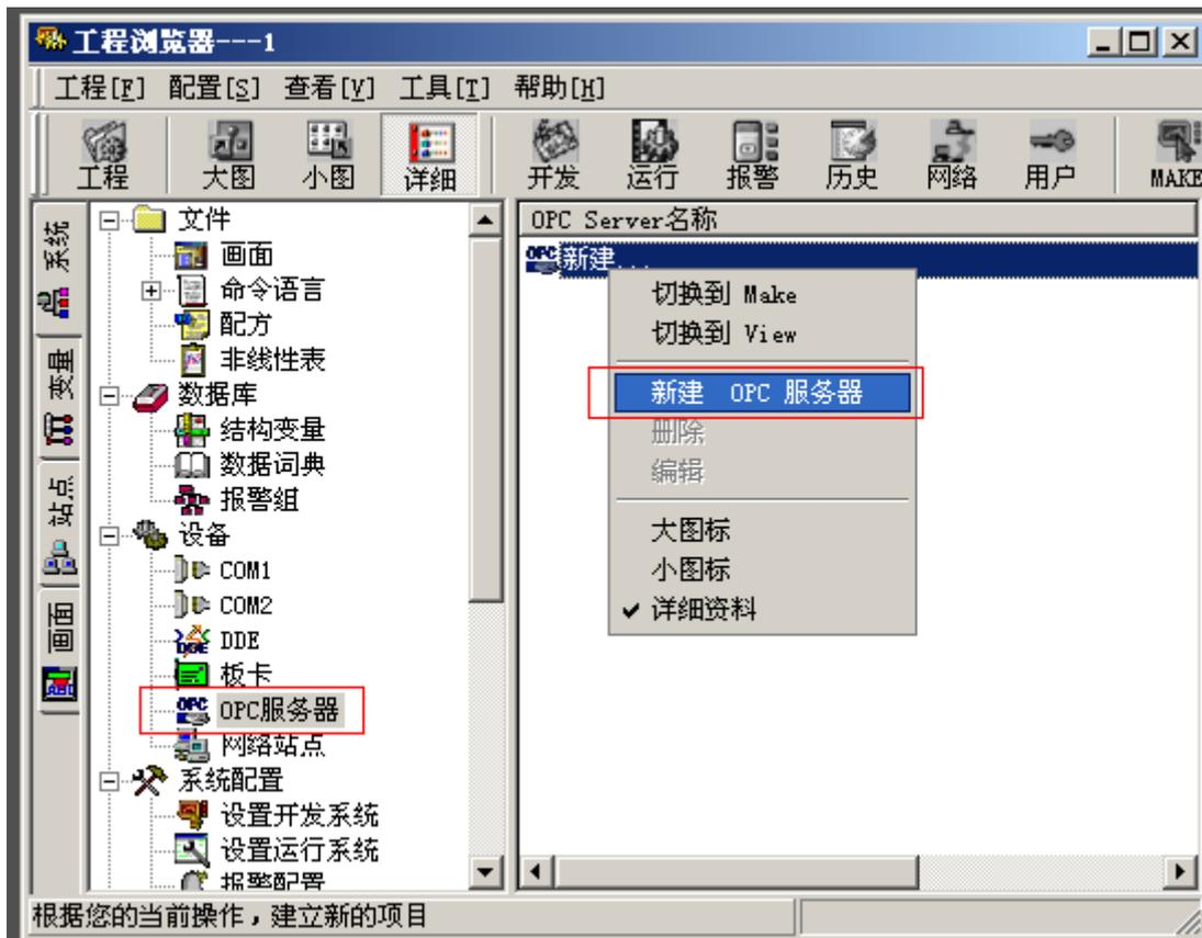
OPC 服务器选择 GrmOpcServer.GRMOPC，读写方式选择“同步读”和“同步写”。如下图所示
