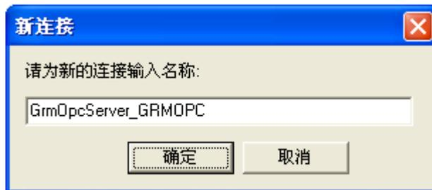
在下图添加变量对话框中，选中 GrmOpcServer\_GRMOPC，点击完成即同时完成创建 OPC 连接和建立 OPC 变量的过程。
