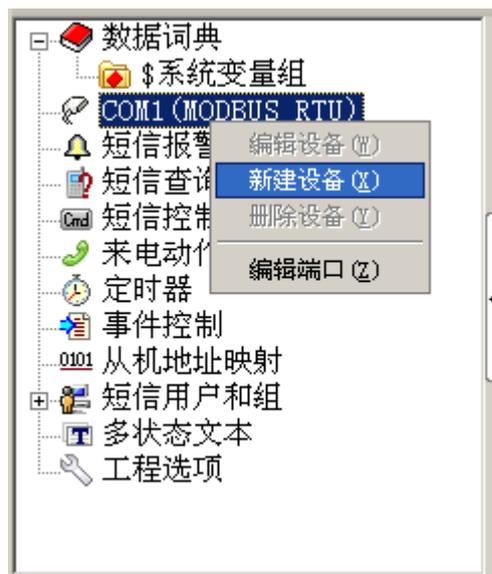
由于新建的设备使用已经建立的端口的完全相同的通讯协议, 因此只需指定设备名和从机地址, 从机地址和连接的 PLC 下面设置的必须一致。在 GRM530 的一个 485 口下, 可以并联多个设备 (设备使用相同的通讯协议, 并具有不同的从机地址)。
