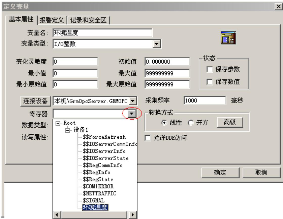
**注意：**GRM 设备内部工程因增加变量、删除变量或修改变量名称而发生变化时，需下载新工程到 GRM530 正常运行后，并使用 GrmOpcMgr 重新刷新 GRM 设备，然后退出组态王，再重新进入组态王回到上图的界面，才能自动获取最新的 OPC 寄存器名。
