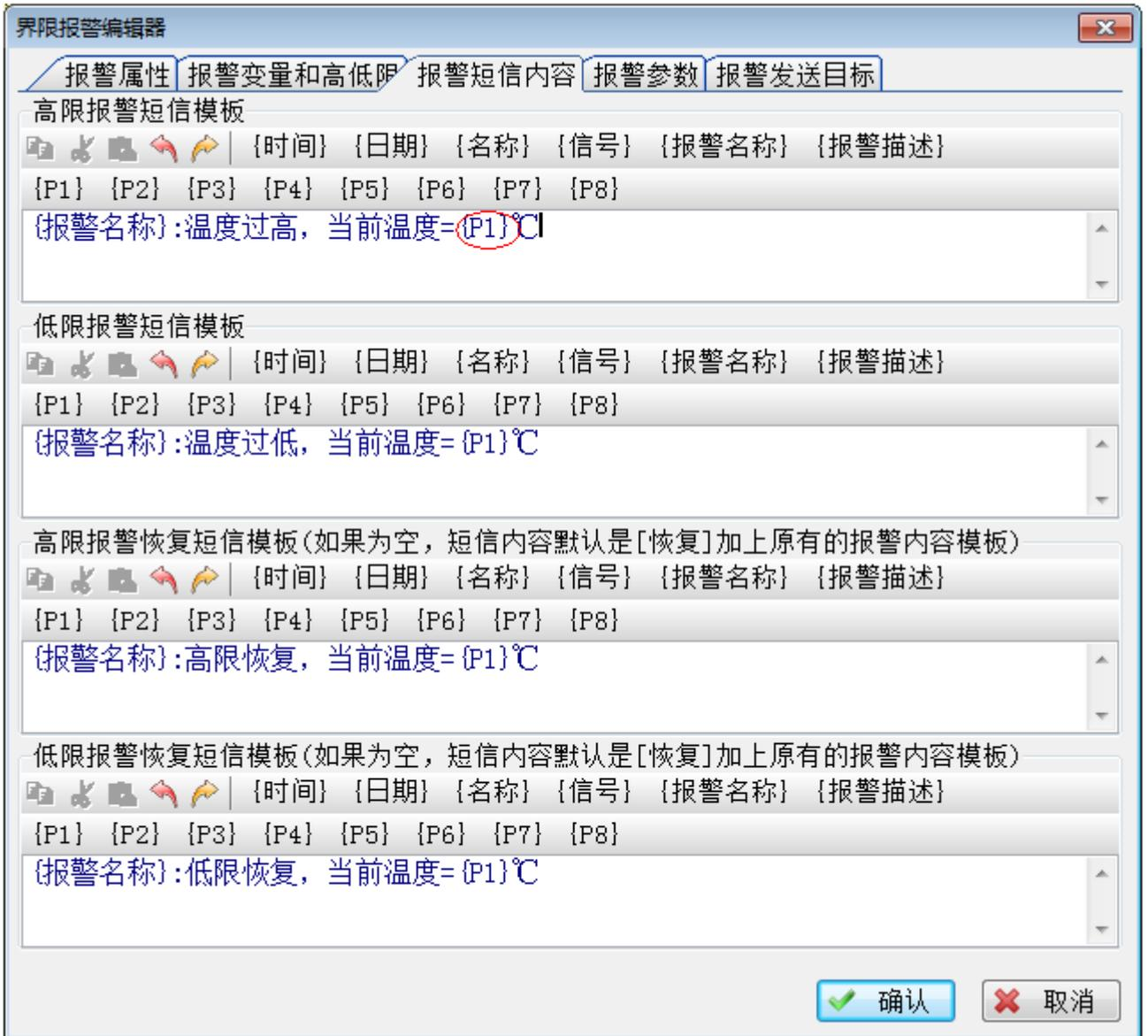
报警消息模板反映了值班人员收到的报警短信的内容。运行过程中，报警消息模板中的报警参数会替换成相应的变量值，或者多状态文本。
