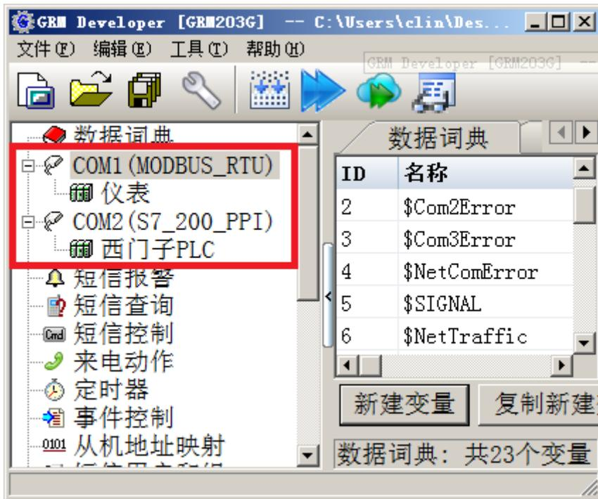
1. 首先配置一个西门子 200 PLC 的变量，MODBUS 的数据将发送到该变量的寄存器地址。
