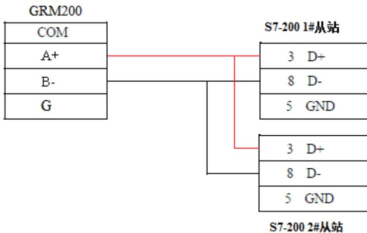
要求 PLC 采用同样的协议，波特率，奇偶校验，停止位相同，从站地址设置为不同（在 PLC 编程软件里面也要设置从站地址）！
