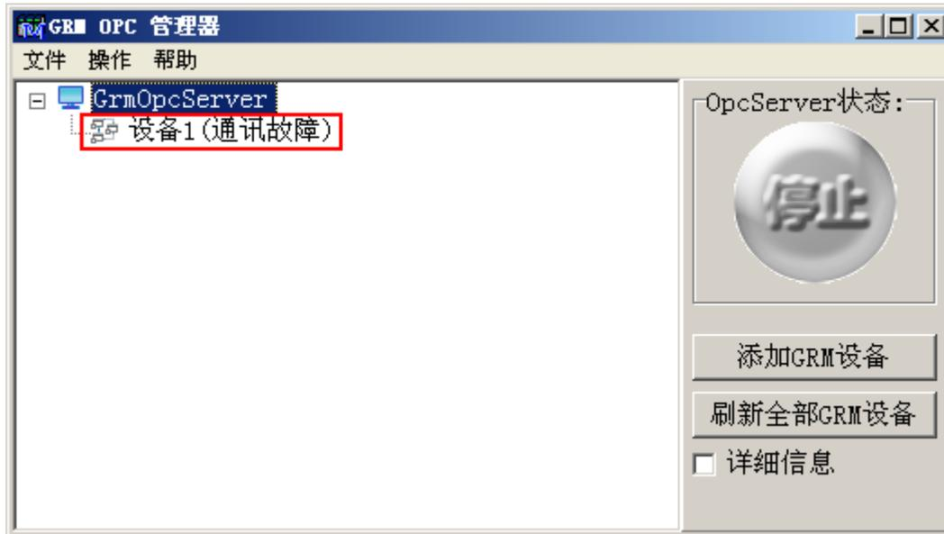
2. 设备序号错误或不存在。输入的 GRM530 设备序号不正确，或者该 GRM530 设备从未连接到巨控云监控服务器。
