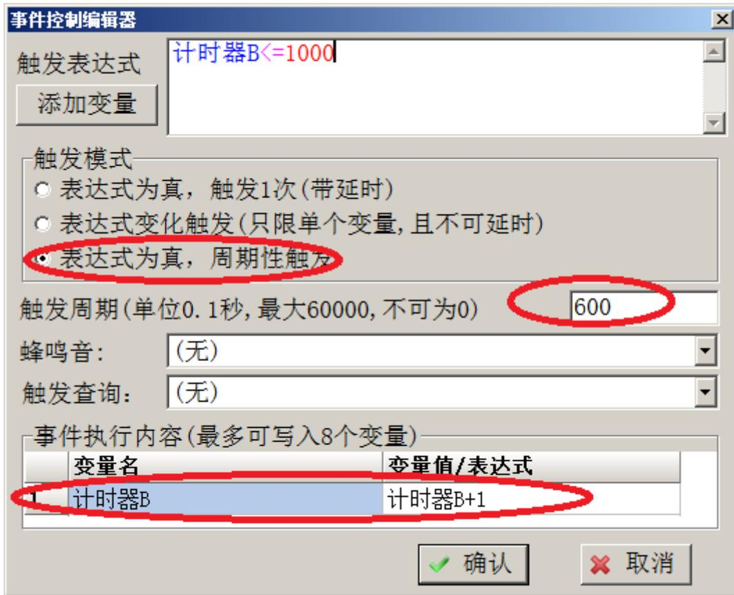
然后利用服务器的数据交换，将清零变量 A 定时赋值给计时器变量 B。
