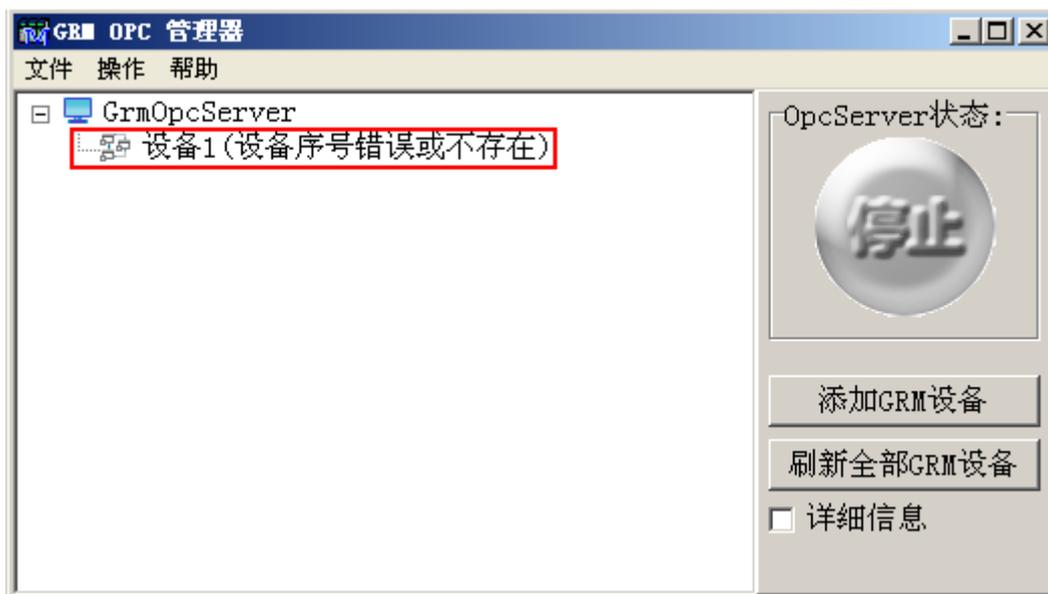
3. GRM 设备通讯故障。表示无法连接到 GRM 设备，原因是 GRM 设备目前不在线，未连接到巨控云监控服务器。请确保 GRM530 已经通电，且数码管闪烁显示“一”。
